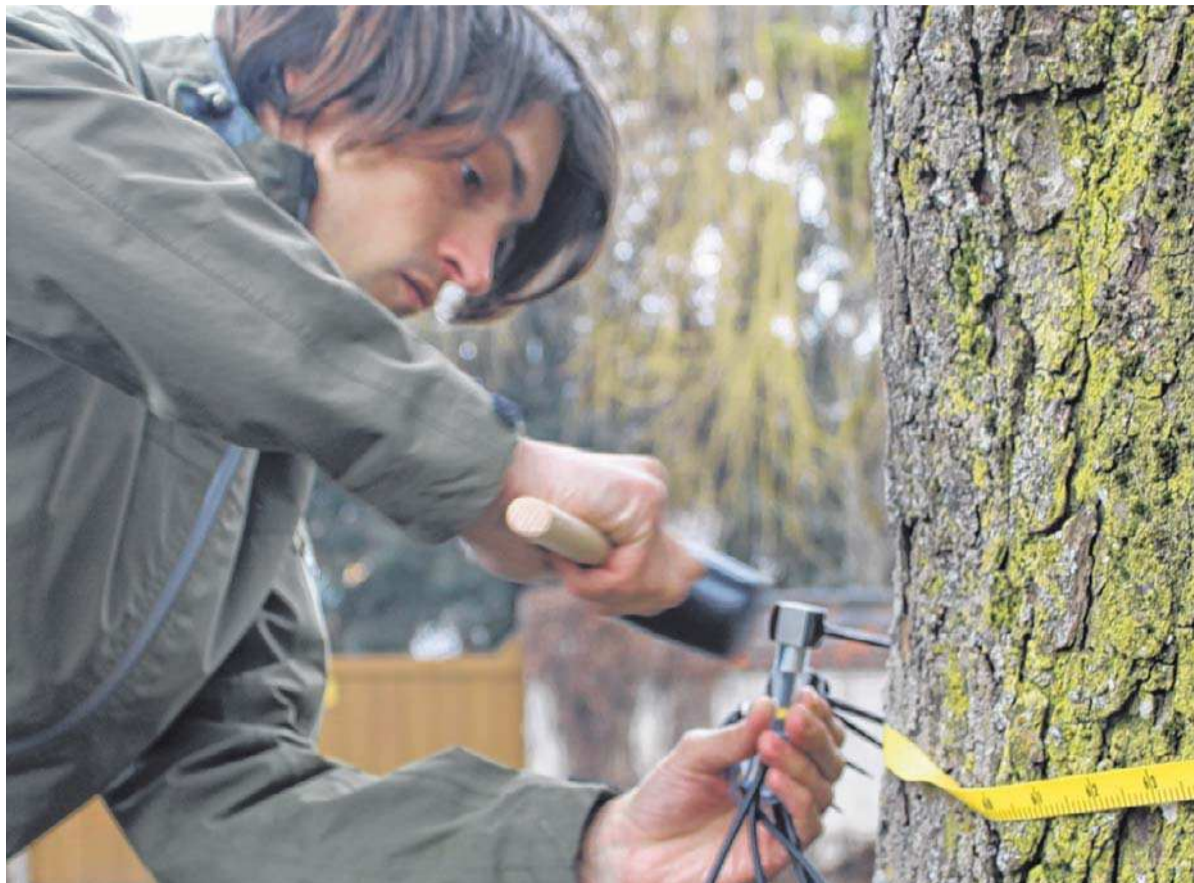
Vorsichtig klopft Baumexperte Philipp Lehner insgesamt zehn Sensoren in die Rinde der 120 Jahre alten Kastanie beim Feuerwehrhaus. Mittels der sogenannten Schalltomografie lässt sich feststellen, ob der Baumstamm tief im Inneren gesund oder geschädigt ist. SZ-FOTO: SABINE CENTNER
